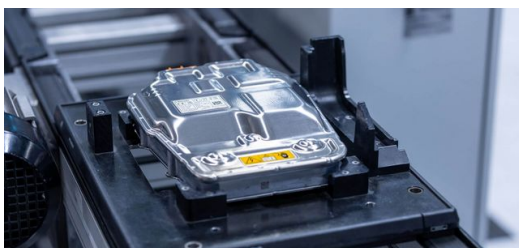
Laser 1 : soudage d'aluminium étanche au gaz. Webasto utilise un laser à
