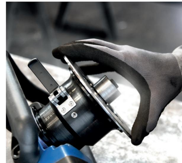
Die Fasenlänge stellen Sie mittels Zahlenring über den Auflageteller ein. Das funktioniert stufenlos und ohne Werkzeug.
