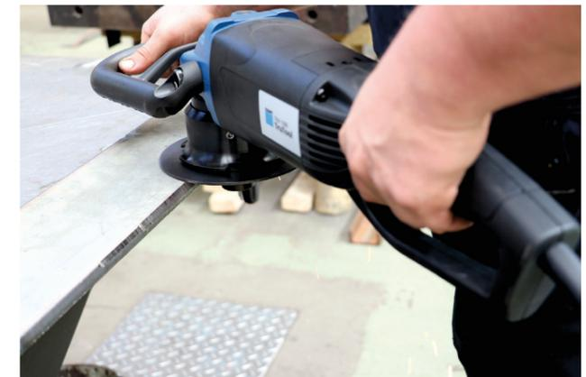
Facharbeiter des Dampfloswerks stellen mit dem Kantenfräser gerade Kanten sowie Innen- und Außenkonturen bis zu fünfmal schneller her, als das mit anderen Verfahren möglich war.
