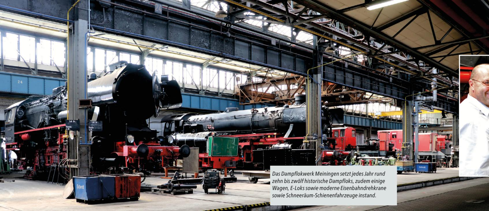
Das Dampfloswerk Meiningen setzt jedes Jahr rund zehn bis zwölf historische Dampfloks, zudem einige Wagen, E-Loks sowie moderne Eisenbahndrehkrane sowie Schneeräum-Schienenfahrzeuge instand.
