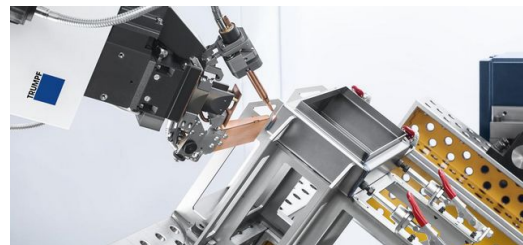
<p>Das neue Verfahren FusionLine verbindet Teile auch dann, wenn Spalte überbrückt werden müssen. Es gleicht Ungenauigkeiten beim Schweißvorgang aus und schließt Spalte mit bis zu einem Millimeter Breite. Viele Bauteile, die für konventionelle<br />Schweißverfahren konstruiert wurden, lassen sich so mit dem Laser bearbeiten. (Foto: Oliver Graf Fotostudio GmbH)</p><p></p></p>
