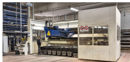
Multitalent: Mit der Lasercell 1005 schweißt und schneidet ELFIM nicht nur 2-D- und 3-D-Bauteile, sie eignet sich auch fürs Laserauftragschweißen. Bild: Antonio & Roberto Tartaglione
