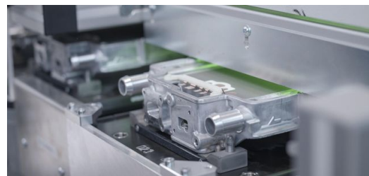
Laser 2: Kupfer kontaktieren mit grünem Laser. Die grüne Wellenlänge der TRUMPF Laser hat einen größeren Absorptionsgrad im Kupfer. Mit der richtigen Pulssequenz lassen sich Einschweißiefen extrem wiederholgenau realisieren – spritzerfrei und ganz ohne Schutzgas.
