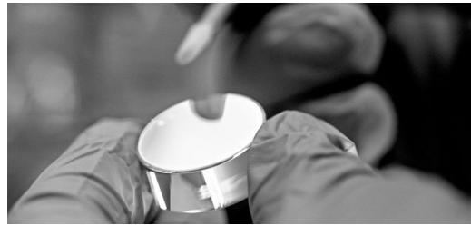
Hier wird ein optisches Element gereinigt. Viele hochspezialisierte Bauteile wie Linsen, Dioden oder Strahlführungskomponenten arbeiten in einer Laserstrahlquelle zusammen. Bild: Manfred Jarisch
