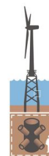
Manuell dauert die Herstellung eines solchen Node, einer Unterwasser-Knotenpunkts für Windkraftanlagen-Gitterkonstruktionen, mehrere Tage. Ein von Force Technology / LWT entwickeltes Verfahren dauert lediglich ein paar Stunden. Illustration: Gernot Walter
