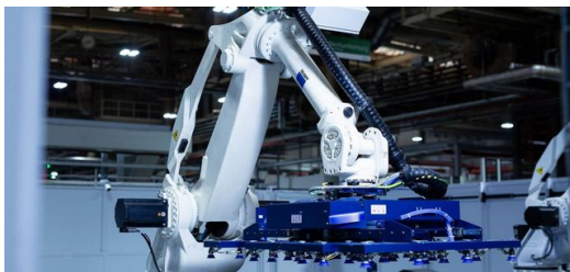
Die zwei Entladeroboter haben gut zu tun: Die Bauteile kommen in Strömen aus der Laserschneidkammer.
