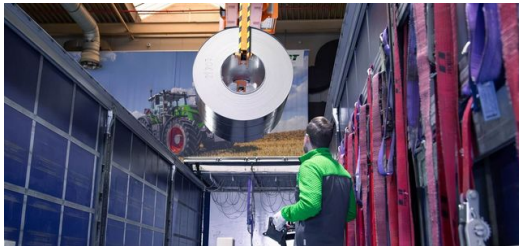
Ein Kranhub ersetzt nun fünf Gabelstaplerfahrten – ein immenser Gewinn an Produktivität.
