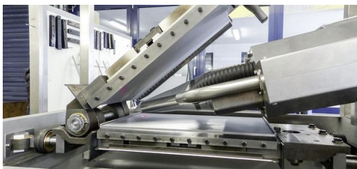
Trotz wenig Platz zwischen den Backplatten reinigt der Laser diese schnell und zuverlässig. Bild: Maria Haas
