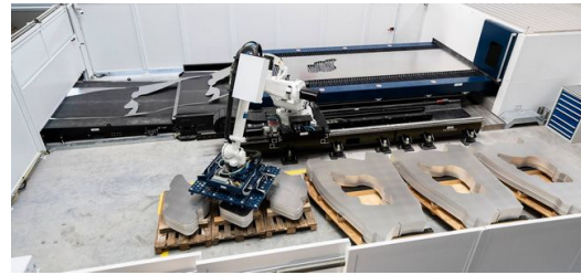
Laserblanking: Ein Roboter sortiert die geschnittenen Bauteile automatisch ab.
