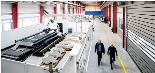
<p>Die 34 Meter langen Laserblanking-Anlage von TRUMPF spart Rohmaterial und rund 4000 Tonnen CO<sub>2</sub> pro Jahr.</p>
