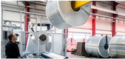
<p>Maschinenbediener Martin Müller hievt ein 16-Tonnen-schweres Alu-Coil in die Beladezone der TruLaser 8000 Coil Edition von TRUMPF.</p>
