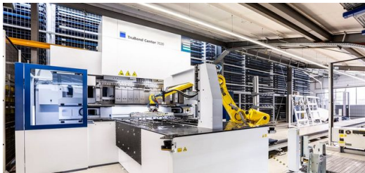
Die TruBend Center 7020 mit Starematik Roboterautomatisierung ist an das vollautomatische STOPA Lager angeschlossen. Nur für die Bereitstellung neuer und den Abtransport beladener Paletten sind Mitarbeiter notwendig.
