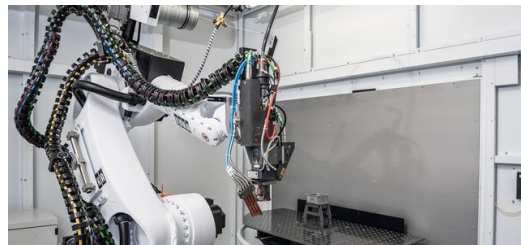
Das Lاسernetzwerk mit einer TruLaser 3030 fiber und einer TruLaser Robot 5020 erweitert das Portfolio von SCS um Laserschneiden und -schweißen. Bild: Peter Oppenländer
