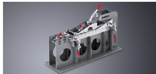
<p> Weil beim Laserschweißen der „Null-Spalt“ das Maß der Dinge ist, braucht es praktisches Wissen um die passende Spannvorrichtung.</p>
