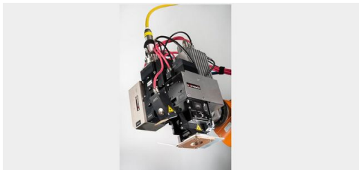
Die serientaugliche Bearbeitungsoptik aus Modulen des Optikherstellers Sansonic ist mit einer hochdynamischen 1D-Scannereinheit ausgestattet, die auch variable Spurbreiten erzeugen kann. Bild: Daimler AG
