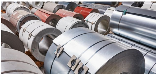
Um alle Kunden innerhalb von 48 Stunden beliefern zu können, hält Wagner ein großes Materiallager vor. Neben Stahlblech von 0,75 bis fünf Millimeter Dicke verarbeitet die Firma auch verzinktes Stahlblech, Alu, Titanzink, Kupfer und Edelstahl. Bild: Florian Bilger
