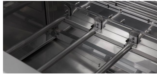
Die vier Edelstahlbrennerstäbe der Gasgrills werden auf einer TRUMPF Laser-Rohrschneidemaschine geschnitten und mit jeweils 144 Löchern versehen. Der nach hinten kleiner werdende Lochdurchmesser garantiert eine gleichmäßige Erhitzung des gesamten Grillrosts.
