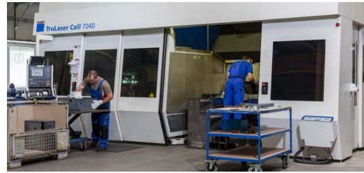
Mit der TruLaser Cell 7040 gelangen Sichtnähte mit bester optischer Güte. Die Mitarbeiter sind in der Lage, auch komplizierte Vorrichtungen innerhalb einer Woche zum Einsatz zu bringen. Bild: Jan Gutzeit
