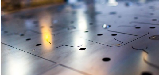
Die Option CoolLine ermöglicht die gezielte Kühlung des Werkstücks und somit ein engeres Schachteln. (Foto: Thomas Abé)
