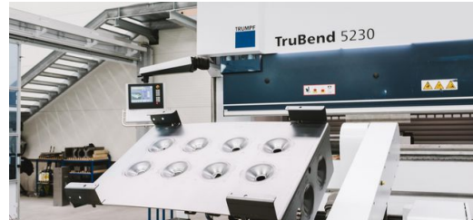
<p>Für die Kesselblechfertigung müssen halbschalenförmige Vertiefungen ins Blech eingebracht werden. Zunächst eine harte Nuss für die TruBend Cell 5000. Heute bewältigt die Biegezelle die Umformung vollautomatisch und spart damit eine Menge Zeit.</p> – Stefan Fuertbauer
