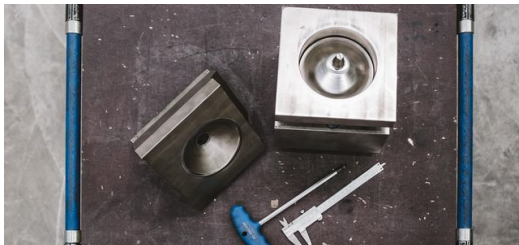
<p>Das von TRUMPF in Pasching speziell für PNH angefertigte Sonderwerkzeug ermöglicht das automatische Einbringen von halbmondförmigen Vertiefungen für die Kesselblechfertigung.</p> – Stefan Fuertbauer
