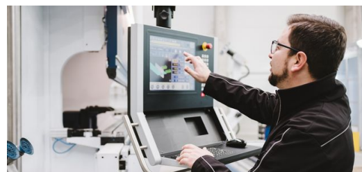
<p>Die TruBend Cell 5000 bietet Martin Mitterhumer was ihm wichtig ist – beispielsweise die kamerabasierte sensorgesteuerte Lageerkennung und die einfache intuitive Bedienung.</p> – Stefan Fuertbauer
