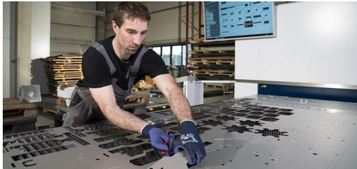
Heute genügt der Blick auf den Bildschirm des Sorting Guide. Auf dem großen Bildschirm wird dem Bediener ein Entnahmevorschlag angezeigt. Alle Teile, die zu einem Auftrag gehören, sind farblich gekennzeichnet.
