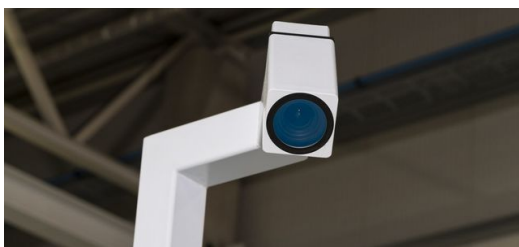
Eine hochauflösende Kamera erfasst jedes entnommene Teil. Die intelligente Bildverarbeitung des Sorting Guide erkennt es zuverlässig und meldet die Entnahme an die Fertigungssteuerung TruTops Fab.
