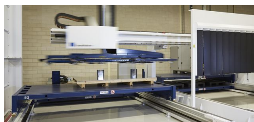
Das automatische Be- und Entladen der Maschine übernimmt der SheetMaster. Er legt die Teile sortiert auf Wagen oder Paletten ab. (Foto: Claus Langer)
