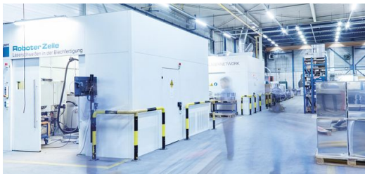
Zwei Laserschweißzellen verbinden Bauteile miteinander. (© Tim van der Most)
