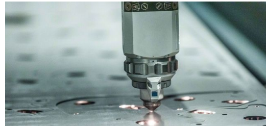
Mit der Option HighSpeed Eco verbraucht DELO beim Schneiden von Edelstahl im Bereich drei bis 20 Millimeter Dicke bis zu 70 Prozentweniger Stickstoff.
