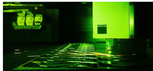
Prozesssicherheit ist für Hans Sanders das A und O. Daher ist er vom Sicherheitskonzept der TruLaser Center 7030 besonders begeistert. Das ist die Bürstentische integrierte SmartGate, verhindert beispielsweise, dass Teile während des Schneidprozesses kippen.
