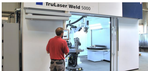
Geld gespart: Bei dem Blechbearbeiter Schink arbeiten die Laserschweißzelle TruLaser Weld 5000 und die Laserschneidanlage TruLaser 3040 im sogenannten LaserNetwork. Sie nutzen also gemeinsam die vier Kilowatt starke Festkörperlaserquelle TruDisk 4001. Foto: Peter Klingauf
