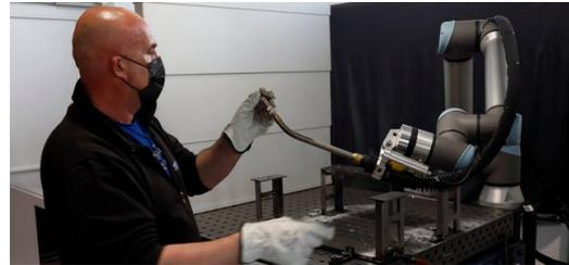
Selbst Losgröße 1 kann rentabler sein als mit Handschweißen, weil gerade das Einstellen und „Teachen“ des Roboterarms äußerst einfach ist. Im Bild: Mitarbeiter Blerim Limani bei der Arbeit an der TruArc Weld 1000.
