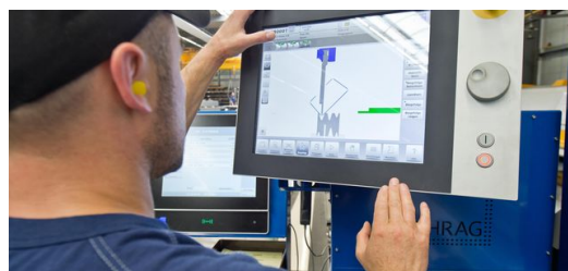
Die Auftragsvolumina bei Schrag bewegen sich von Stückzahl eins bis hin zu 20 Tonnen-Aufträgen, die nicht nur qualitativ hochwertig, sondern meistens auch sehr schnell abgearbeitet werden müssen. Die VarioPress 400 bei Schrag weist eine höhere Motorleistung auf und verfügt über eine zusätzliche H-Achse vorne, die das Kanten von Z-Profilen ermöglicht. Bild: Dirk Egelkamp
