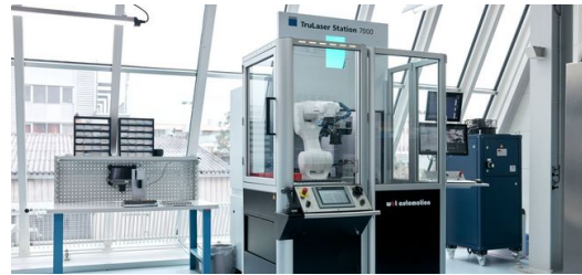
<p>Effizientes Duo: Am schweizerischen Standort Widnau schweißt der Endoskop-Hersteller Karl Storz Okulare auf einer TruLaser Station 7000. Eine mobile Roboterzelle übernimmt das Be- und Entladen der Bauteile.</p>
