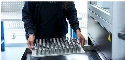
<p>Die Automatisierungszelle ist mit vier Schubladen ausgestattet. 960 Bauteile haben darin Platz. Sie werden parallel zum Schweißprozess be- und entladen.</p>
