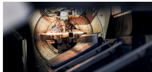
<p>Features wie direktes Editieren, die Möglichkeit zur Simulation sowie die automatische Programmierung von NC-Programmen auf Basis der 3D-CAD Konstruktion in Tube Design stellen sicher, dass 99 Prozent aller Teile, ohne Bedieneringriff so aus der Maschine laufen, wie es sein muss. (Bild: Stefan Hobmaier)</p>
